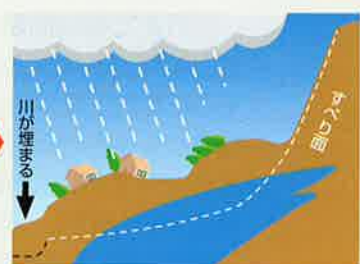
③人家・道路が崩壊。土砂が川を埋め、下流に氾濫して大洪水になる
